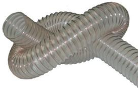
Gaine en polyuréthane (PU) très flexible et durable, qu'on peut utiliser pour le transport d'air de matières abrasives. Qualité résistant à l'hydrolyse et aux bactéries. Grande résistance à l'abrasion et à la déchirure. Mise à la terre par connexion des extrémités du fil d'acier.
